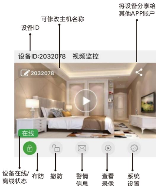
a) 浏览视频：在我的设备列表界面，点击设备图片中的播放按钮，即可进入监控画面。画面中可对设备进行布撤防操作、拍照、监听、喊话及预置位设置。浏览视频可选择高清、标清及流畅三种分辨率进行监控。监控设备视频时可滑动屏幕操作云台转动方向来观看不同位置的图像。支持预置位功能设置，可查询、设置或删除1-8防区相对应的云台预置位。在监控主界面，点击预置位功能按钮，画面右侧会自动弹出1-8防区的数字按钮。短按其中一个数字按钮，设备云台会自动移动到这个防区已设置的云台位置；长按数字键，界面会弹出设置和删除防区预置位的操作界面。
