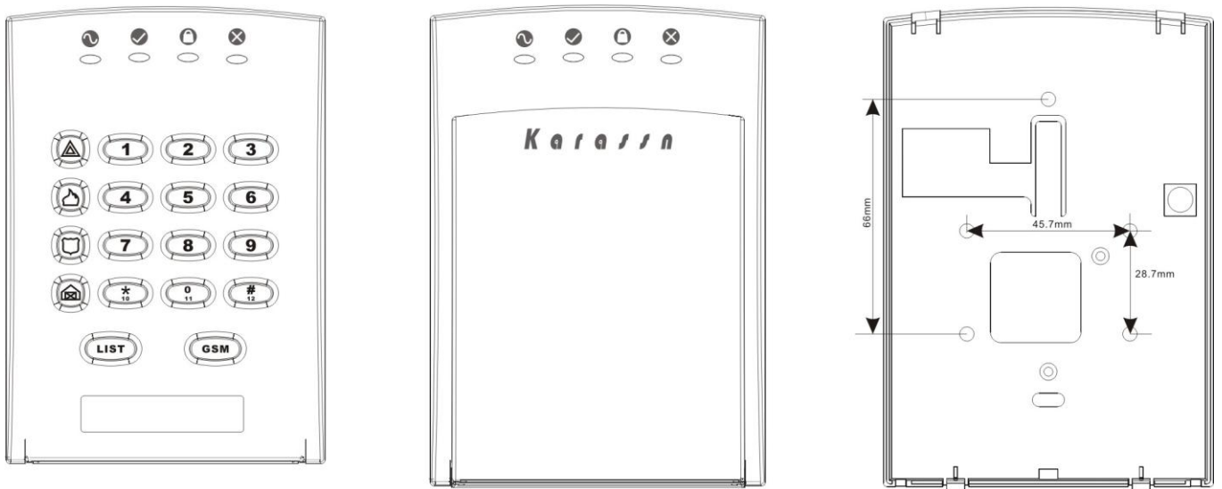
图六 键盘底盖面板图和安装图
