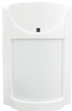
本产品采用双元红外传感器结合先进的数字信号处理技术，具有自动温度补偿功能，其原理是通过检测人体辐射的红外热能而启动主机相应报警。具有受环境影响小、误报率低，安全可靠、安装使用方便等优点。
